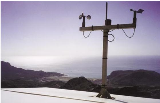
Sensores de velocidad y dirección de viento en un aerogenerador
