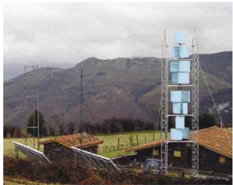
Aerogenerador con rotor Savonius
