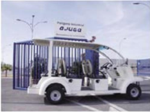
Fig.33. Don Qhyxote Car 07: Vehículo propulsado con un sistema de propulsión de pila de combustible PEM desarrollado por AJUSA. Su depósito de hidrógeno a 350 bar permite una autonomía de 120 kms.
