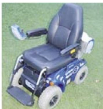
Fig.31. Silla de minusválidos con hidrógeno dotada de un dispositivo de almacenamiento de hidrógeno (BESEL)
