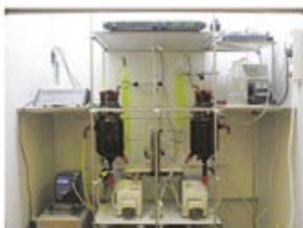
Fig.15. Planta escala bancada de una planta de electrosíntesis de oxidantes. Producción de hidrógeno como subproducto. (UCLM)
