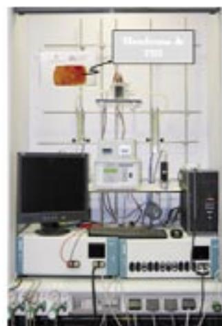
Fig.14. Planta escala bancada de una pila de combustible tipo PEM de alta temperatura. Detalle de una membrana de PBI desarrollada en el DIQ de la UCLM.
