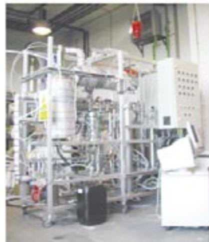
Fig.12 Prototipo de reformador de diesel.
