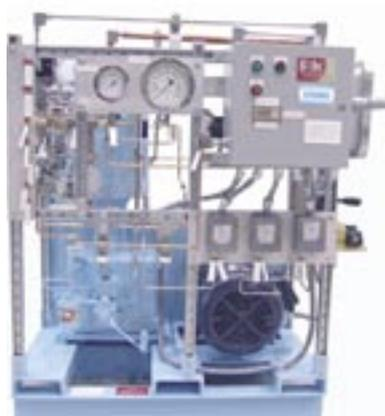
Fig.5. Compresor de diafragma metálico.
